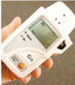
Der Datenlogger kann die Daten nach der Messung für die Meldebehörde auslesen.
